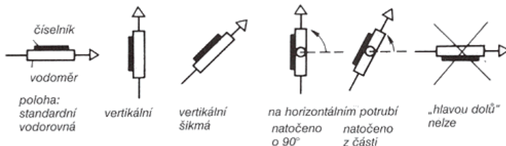
Obr.3 - Možné polohy vodoměru
